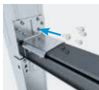
Pocket-Kit vormontiert auf Montagehilfe setzen, rechtwinklig ausrichten und verschrauben
