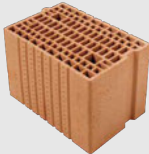
Porotherm 25-38 Plan für tragende Innenwände Format: 25 x 37,5 x 24,9 cm Bedarf: 10,5 Stk./m 2
