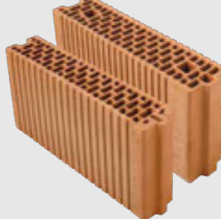
Porotherm 25-38 Plan für nichttragende Zwischenwände Format: 10/12 x 50 x 24,9 cm Bedarf: 8 Stk./m 2
