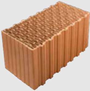
Porotherm 50 H.i Plan U-Wert: 0,16 W/m 2 K (verputzt) Format: 50 x 25 x 24,9 cm Bedarf: 16 Stk./m 2
